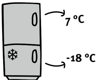
Stellen Sie Ihren Kühlschrank auf eine Temperatur von  $7\text{ °C}$  ein (Stufe 2 oder 3). Überprüfen Sie das per Thermometer. Je kälter, desto mehr Strom wird benötigt.
